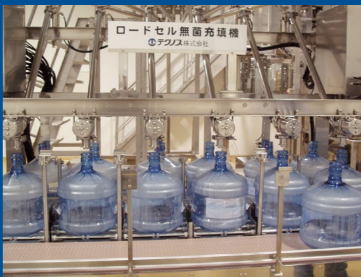
ロードセル無菌充填機（能力1,000本/時 at 3ガロン）
