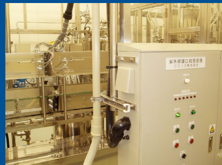
紫外線塚口殺菌装置の制御盤
