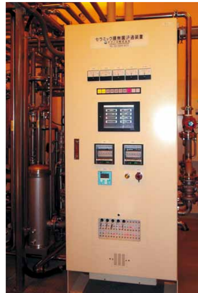
テクノセラミック膜無菌濾過システム Ceramic Membrane Aseptic Filtering Equipment
