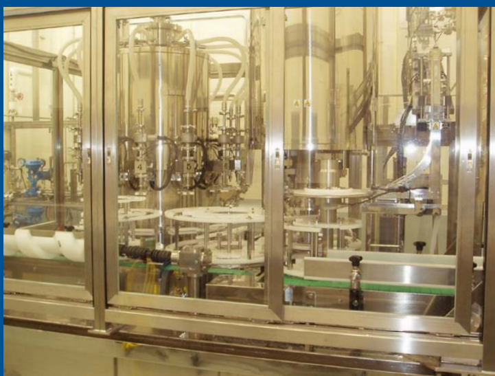
無菌充填機/サーボキャッパー（クリーンブースクラス100付）
